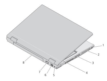
1 ワイヤレススイッチ 2 ExpressCard/54 スロット 4 USB コネクタ (2) 涌気孔 AC アダプタコネクタ 6 ネットワークコネクタ 8 ビデオコネクタ バッテリ
